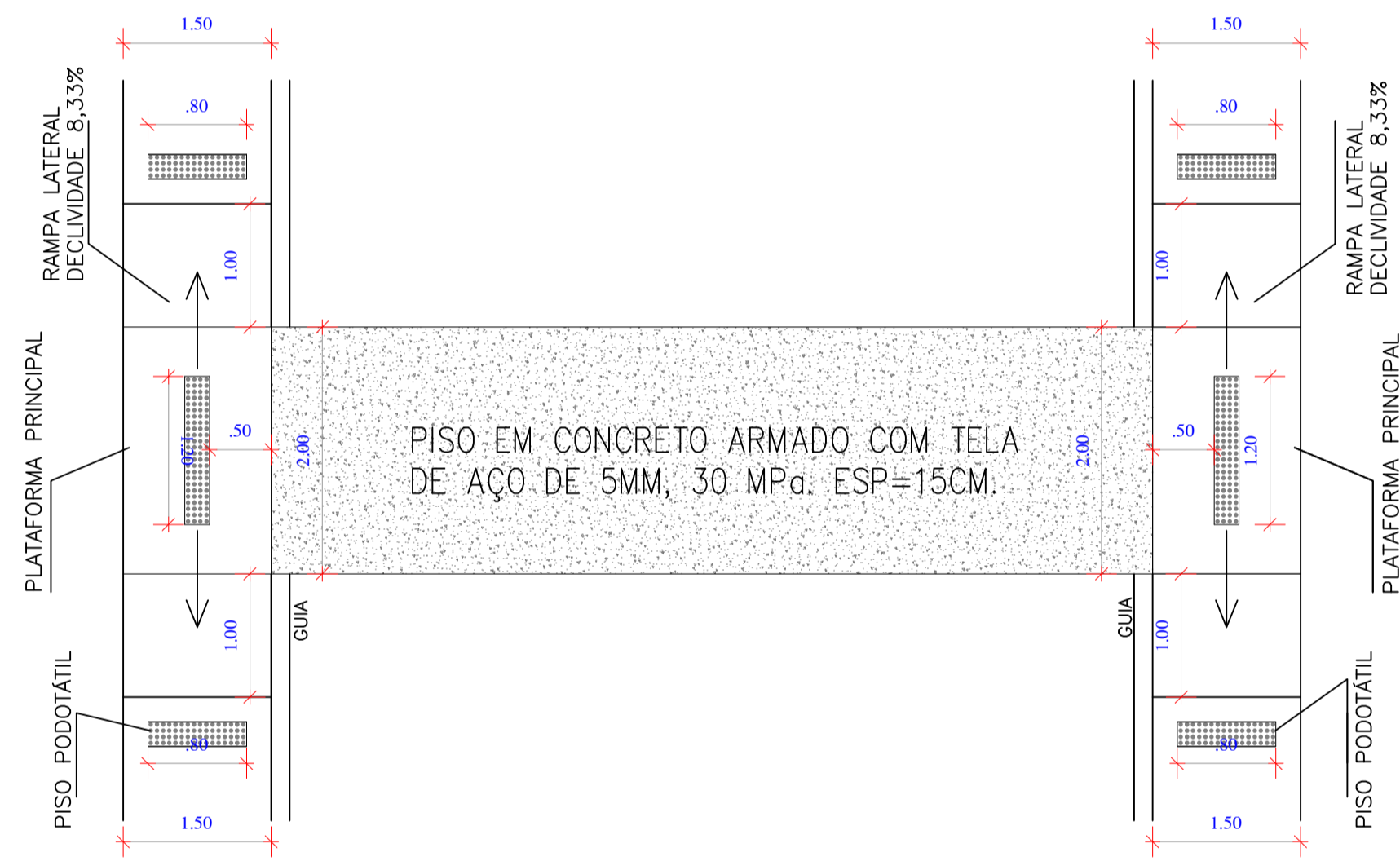
05 DET. RAMP E PISO ESCALA — 1 : 50
